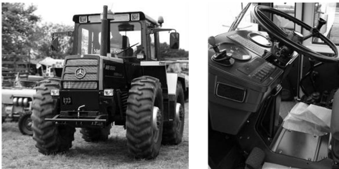
**Рисунок 6 - Универсальный трактор с реверсивным постом управления «МБ-трак» 1300 фирмы Mercedes Benz, ФРГ**
