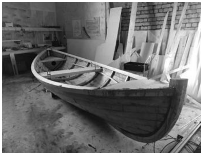
Рисунок 2- Строительство сельдяного карбаса из фанеры в мастерской «Арктического музея лодки». Фото из архива музея
