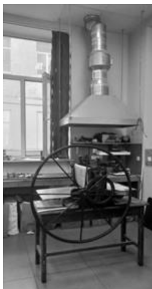
Рисунок 8. Офортный станок в литографской мастерской кафедры рисунка СПбГАСУ
