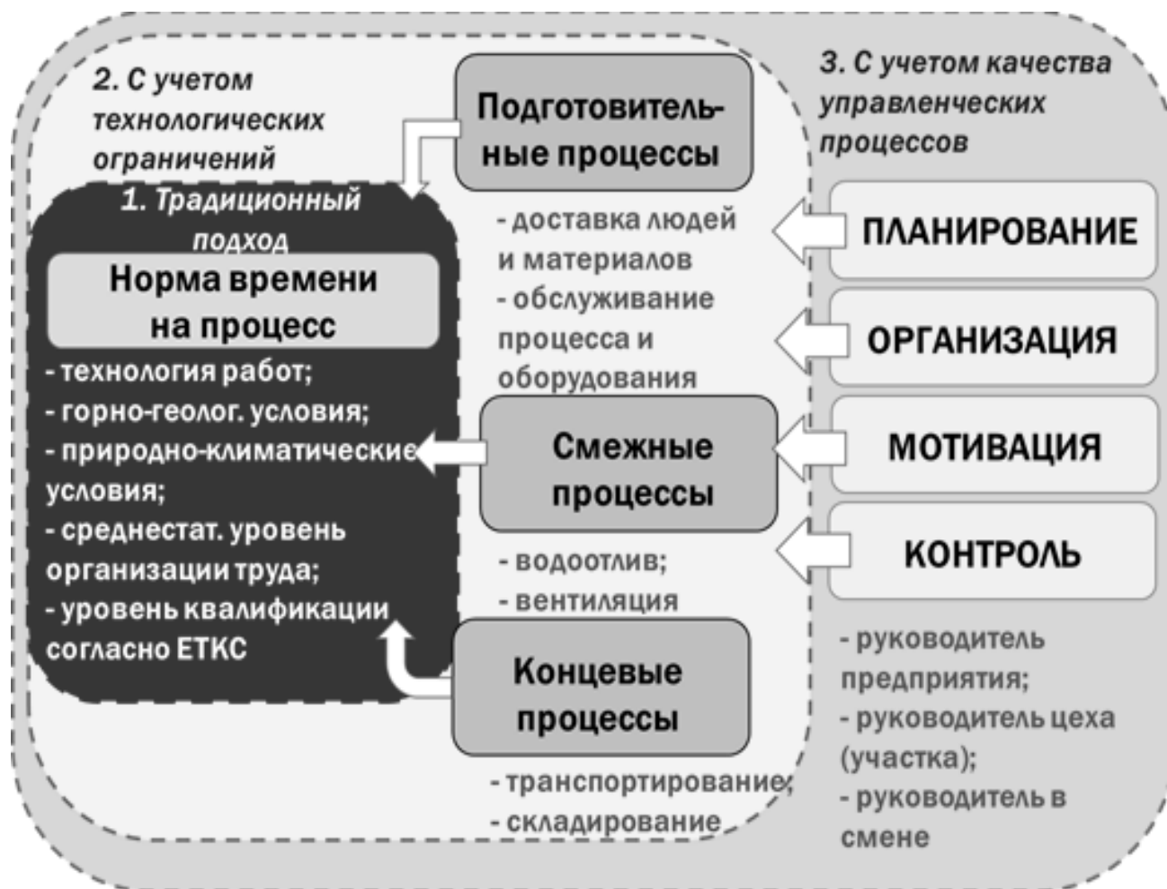
Рисунок 3 - Методический подход к разработке норм времени на выполнение производственного процесса с учетом качества планирования, организации, мотивации и контроля параметров трудового процесса
