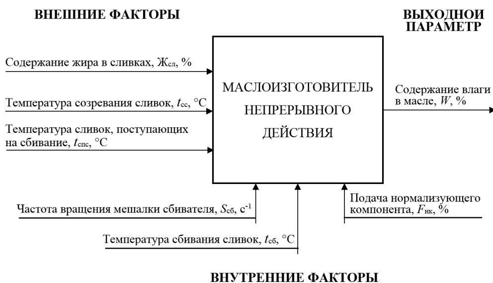
Рисунок 1 - Структурно-параметрическая схема производства сливочного масла в маслоизготовителе непрерывного действия
