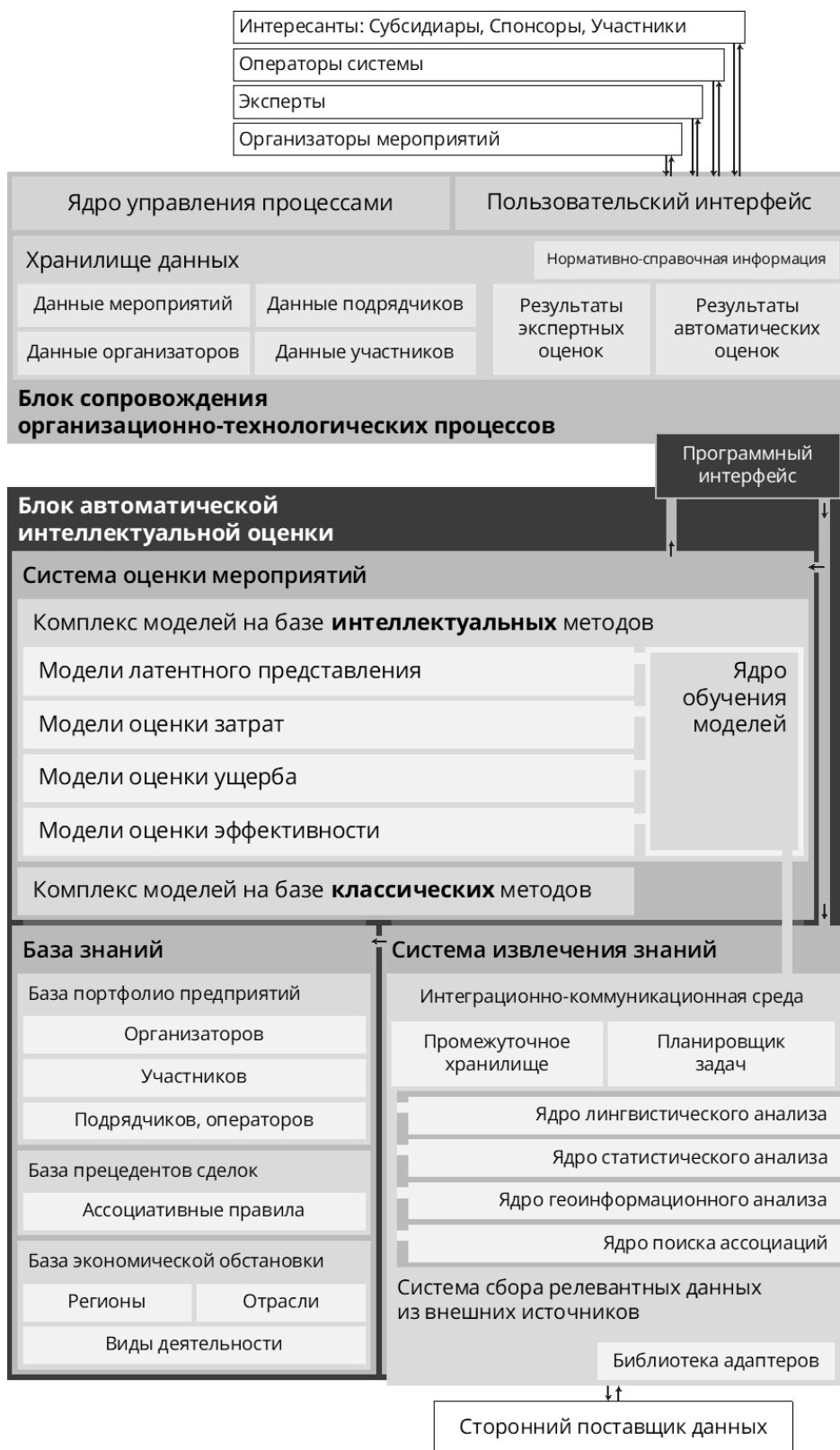
Рисунок 1 - Функциональная архитектура автоматизированной информационной системы сопровождения процессов принятия решений по оценке экономических показателей мероприятий
