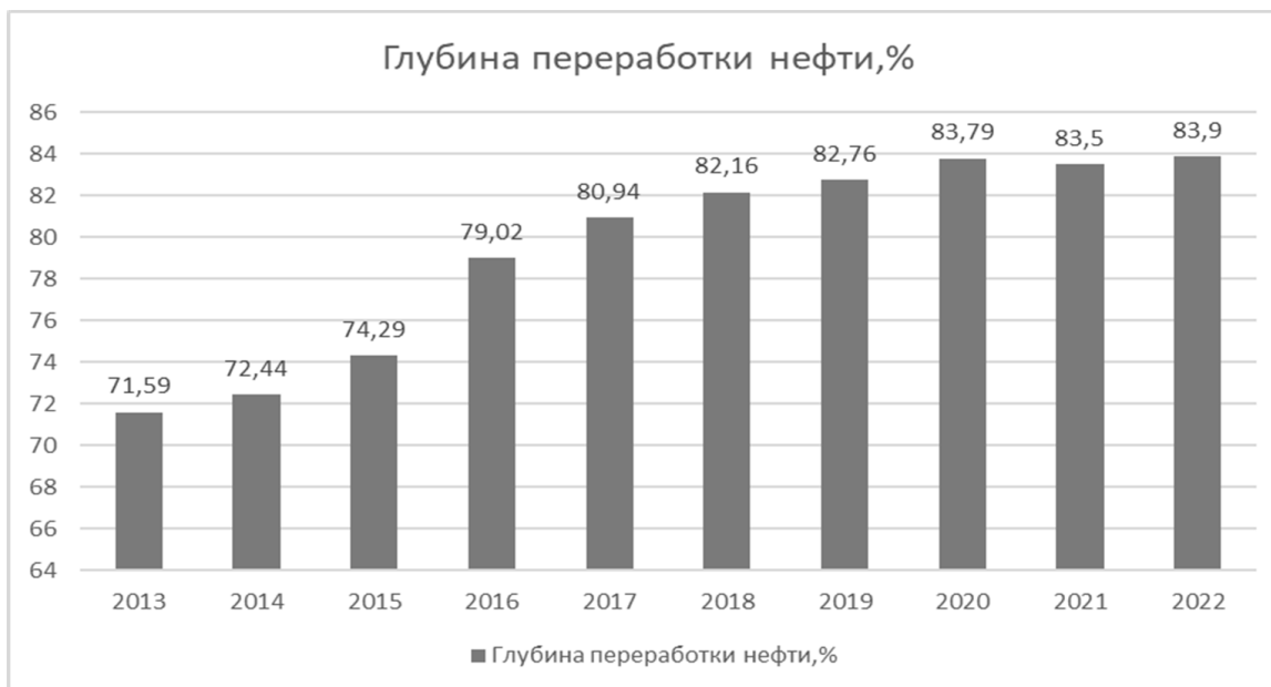
Рисунок 2 - Глубина переработки нефти в % 2013-2022 г.
