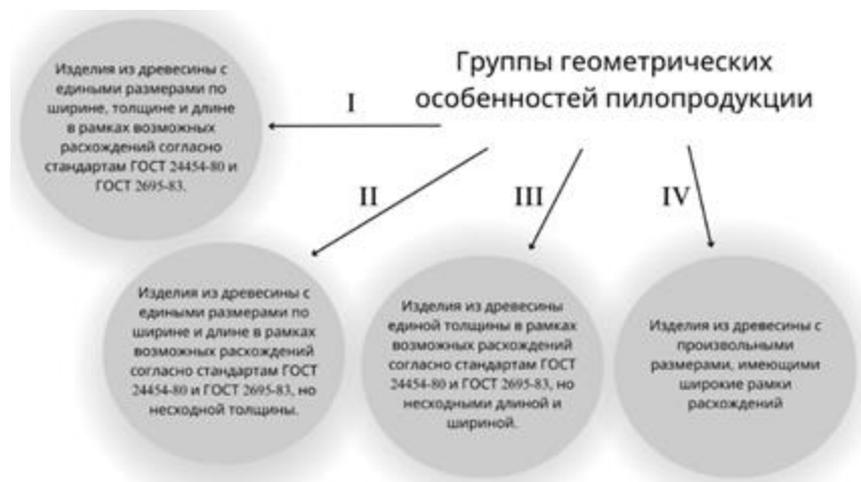
**Рисунок 2 - Категории единиц пилопродукции в соответствии с их геометрическими характеристиками**
