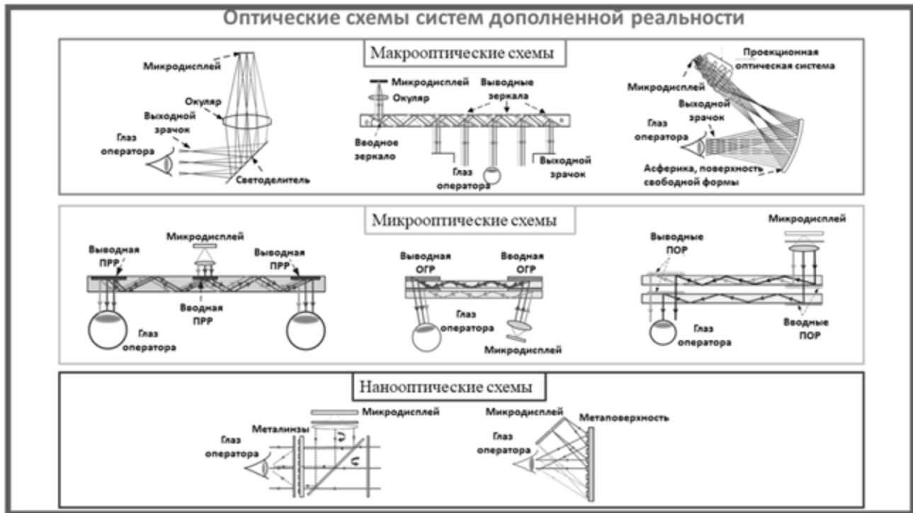
Рисунок 2 - Оптические схемы систем дополненной реальности
