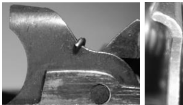
Рисунок 2 - Отражатель классической формы и размеров пистолета Макарова (вид с левой и передней части оружия при неполной разборке)
