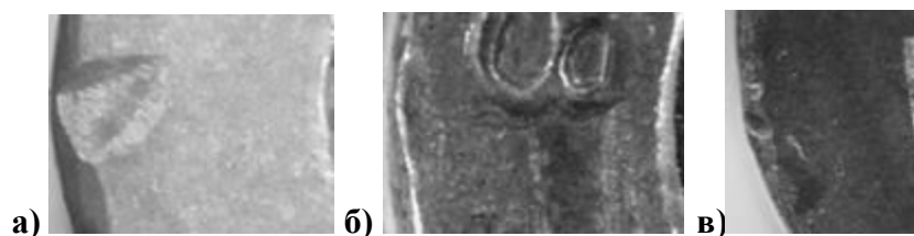
Рисунок 4 - Следы на донных частях гильз образованные 2-м, 7-м и 8-м экземплярами испытываемого оружия первой отобранной категории
