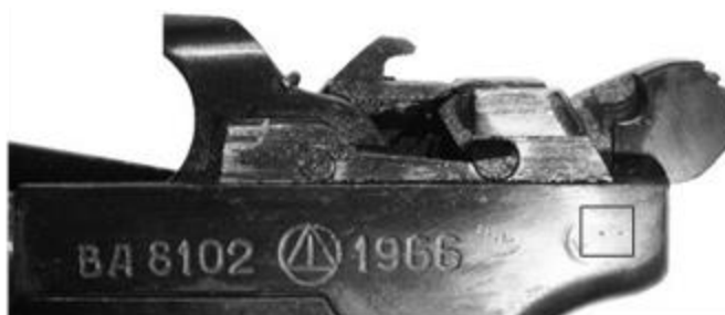
Рисунок 14 - Пистолетная рамка с УСМ пистолета Макарова калибра 9 мм (1966 год выпуска); прямоугольником отмечены точки контроля твёрдости
