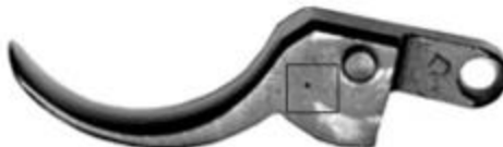
Рисунок 10 - Спусковой крючок пистолета Макарова калибра 9 мм (1966 год выпуска); прямоугольником отмечены точки контроля твёрдости
