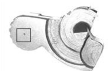
Рисунок 11 - Курок пистолета Макарова калибра 9 мм (1966 год выпуска); прямоугольником отмечены точки контроля твёрдости
