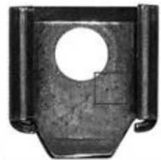
Рисунок 9 -. Задвижка боевой пружины с резьбовым отверстием пистолета Макарова калибра 9 мм (1966 год выпуска); прямоугольником отмечены точки контроля твёрдости
