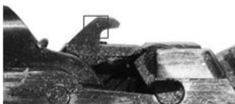
Рисунок 13 - Шептало с пружиной пистолета Макарова калибра 9 мм (1966 год выпуска); прямоугольником отмечены точки контроля твёрдости
