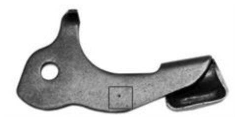
Рисунок 12 -Затворная задержка боевого пистолета Макарова калибра 9 мм (1966 год выпуска); прямоугольником отмечены точки контроля твёрдости
