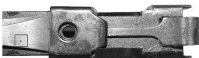
Рисунок 7 - Мушка пистолета Макарова калибра 9 мм (1966 год выпуска); прямоугольником отмечены точки контроля твёрдости
