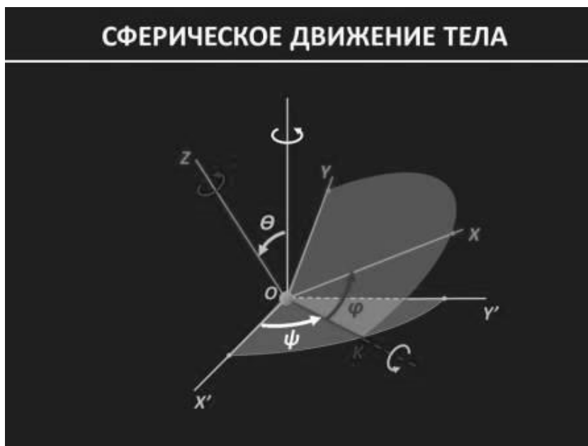
Рисунок 1 - Результат последовательного построения углов Эйлера при изучении сферического движения тела
