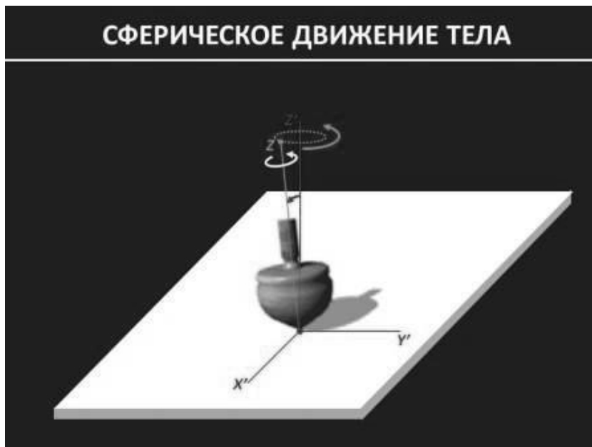
Рисунок 2 -Анимация движения волчка в качестве примера сферического движения тела
