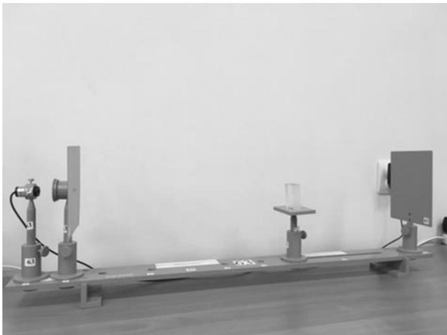
**Рисунок 6 - Установка для проведения лабораторной работы для усвоения понятия интерференция света**
