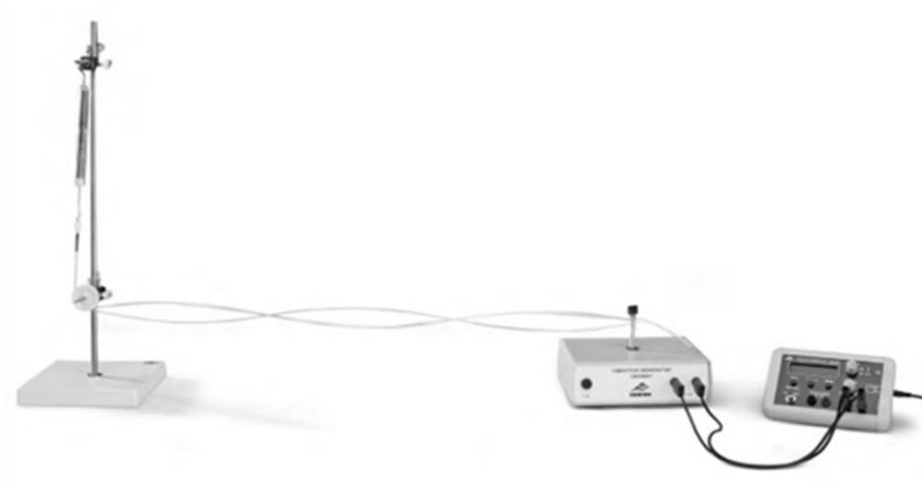
**Рисунок 1 – Шнур, цилиндрическая пружина, динамометр и функциональный преобразователь**
