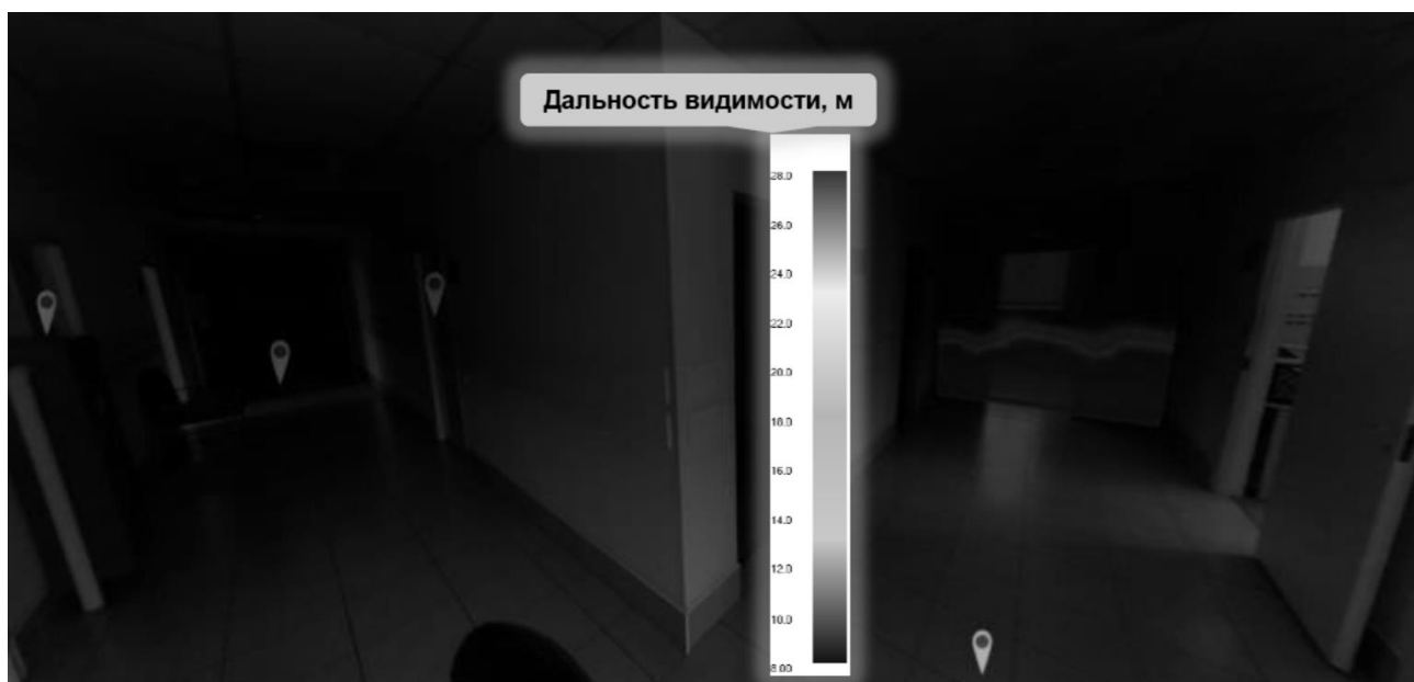
Рисунок 9 - Виртуальное пространство в обучающем режиме с наложенной плоскостью, отображающей поля дальности видимости в дыму
