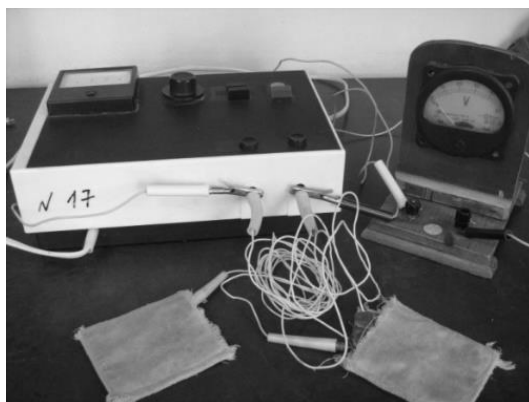
Рисунок 1 - Лабораторное оборудование по физике с использованием медицинского прибора для лечебного электрофореза
