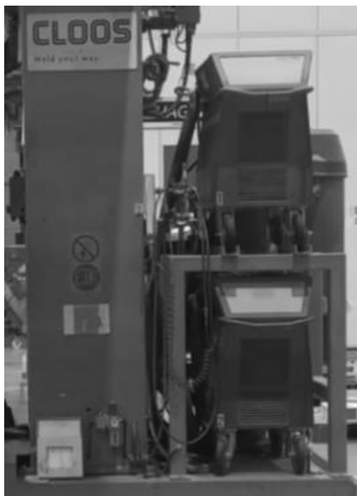
Рисунок 3 – Источники питания сварочной дуги Closs 603 с двумя вынесенными панелями QUINTO управления на рабочее место операторов сварочных установок,
